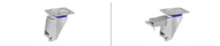
Este tipo de soporte resulta adecuado para usos medios pesados (máx. 500 kg). La presencia de dos hileras de bolas y el contacto directo entre la platina y el anillo de retención de las bolas a través del perno integrado garantizan una excelente maniobrabilidad y juegos muy reducidos.
